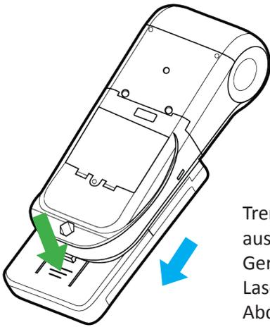
Trennen Sie das Smartphone aus dem Körper des Gerätes, drücken Sie die Lasche an der Unterseite der Abdeckung und schieben Sie sie in Richtung der blauen Pfeile.
